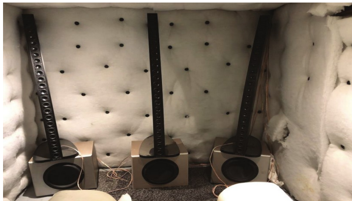
Figure 2: Les hauts-parleurs installés dans la salle semi-anéchoïque
